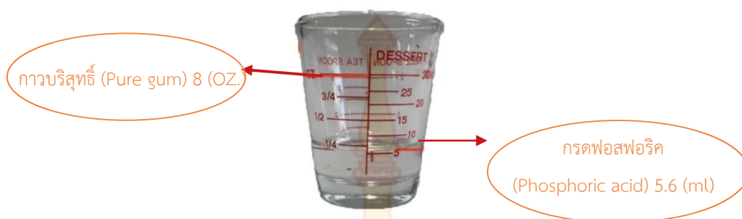
ภาพที่ 29 ขั้นตอนการเตรียมกาวกรด ส่วนผสมปริมาณกาวกรด (Gum Etch)
