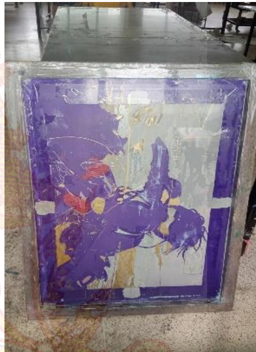
ภาพที่ 30 ภาพการลอกภาพต้นแบบลงบนบล็อกสกรีน
