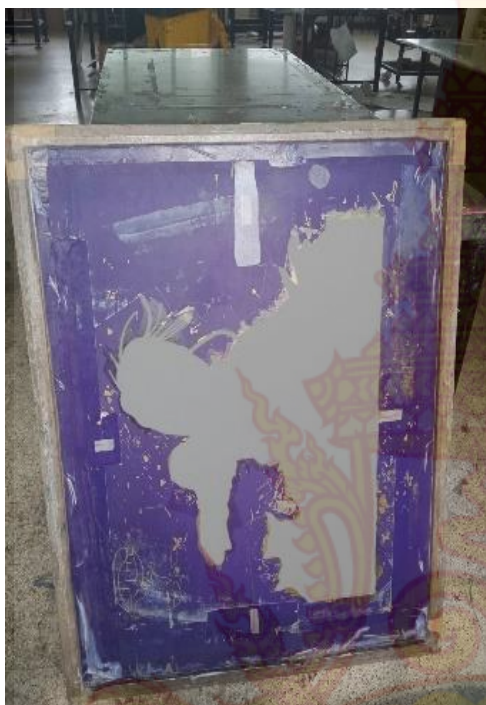
ภาพที่ 30 ภาพการลอกภาพต้นแบบลงบนบล็อกสกรีน
