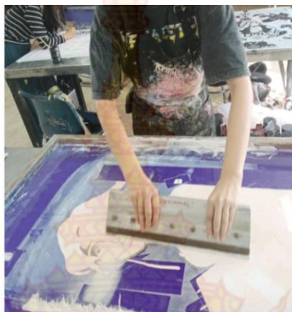
ภาพที่ 33 ภาพการนำบล็อกที่เขียนน้ำยาวานิชตากจนแห้งแล้วนำมาปาดสีที่ 1 ที่มา : ข้อมูลจากผู้เขียน
