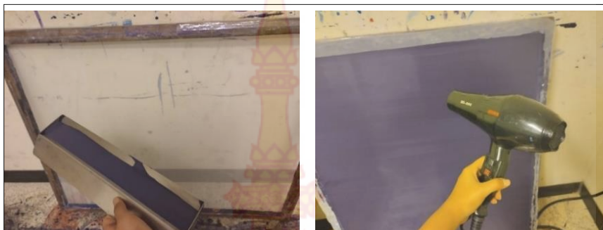
ภาพที่ 43 ภาพปาดกาลงบนผ้าแม่พิมพ์
