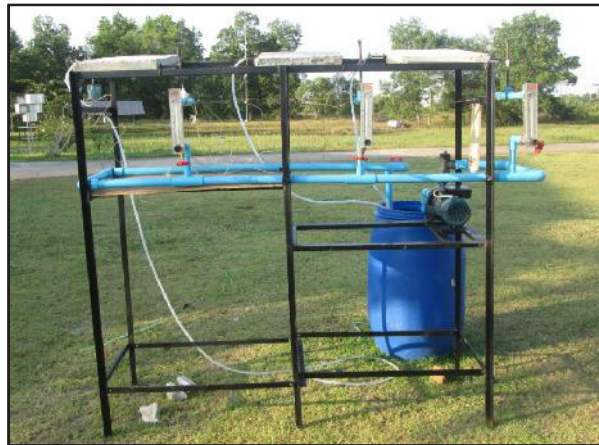
รูปที่ 2 ชุดทดลองระบบผลิตน้ำร้อนพลังงานแสงอาทิตย์ชนิดแผงรับความร้อนปูนซีเมนต์
