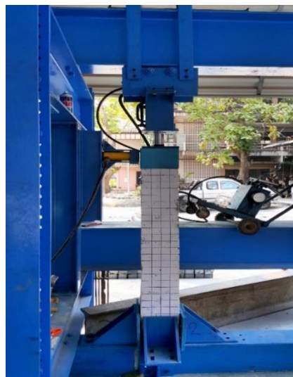
รูปที่ 6 ติดตั้งไฮดรอลิกเข้ากับโครงเฟรมและตัวอย่างเสา
