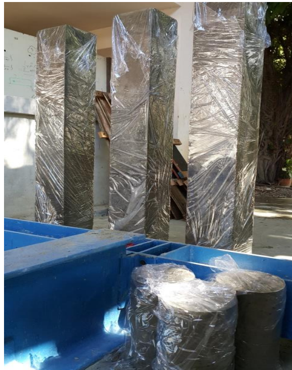
รูปที่ 5 ขึ้นตัวอย่างเสาที่กำลังบ่มด้วยพลาสติก
