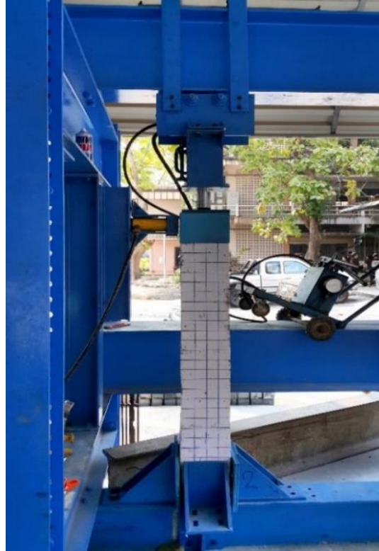
รูปที่ 2 เครื่องมือทดสอบแรงกระทำด้านข้างแบบสถิตยศาสตร์
