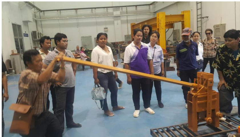
รูปที่ 3 การขึ้นรูปตัวอย่างอิฐบล็อกประสานจากเศษหินแอนไฮไดรต์ (บรรยากาศการฝึกอบรมให้ชุมชน)
