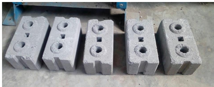
รูปที่ 4 ลักษณะอิฐบล็อกประสานจากเศษหินแอนไฮไดรต์กองบ่มในสภาพอากาศปกติ
