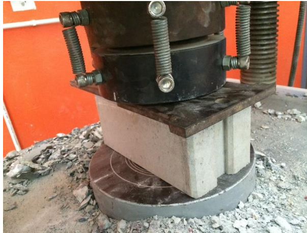
รูปที่ 5 การทดสอบความต้านทานแรงอัดของก้อนตัวอย่างอิฐบล็อกประสาน
