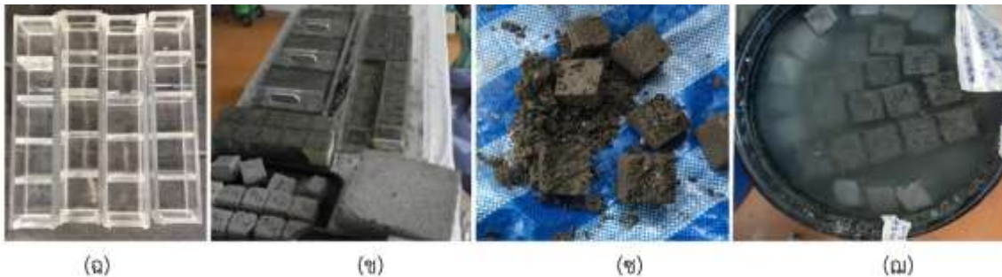
รูปที่ 2 แสดงการขึ้นรูปคอนกรีตบล็อก
