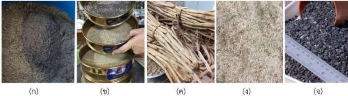
รูปที่ 1 แสดงการเตรียมส่วนผสมของคอนกรีตบล็อก
