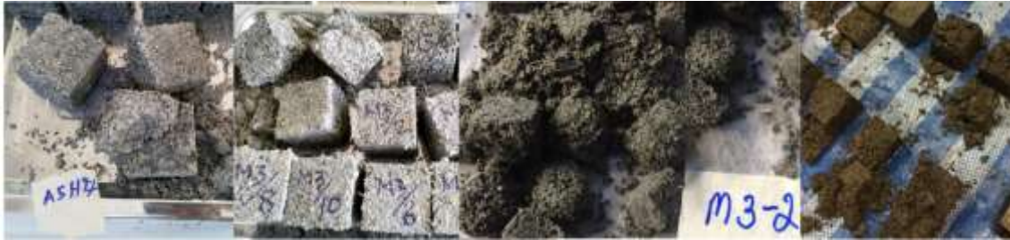
รูปที่ 5 คอนกรีตบล็อกที่มีส่วนผสมของใยผักตบชวา 2% แยกหักง่ายเมื่อถอดแบบ
