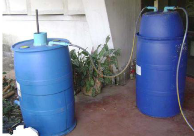
รูปที่ 4 ถังหมักก๊าซชีวภาพและถังเก็บก๊าซชีวภาพจากเศษวัชพืชทางการเกษตรและมูลสัตว์ [ 2 ]
