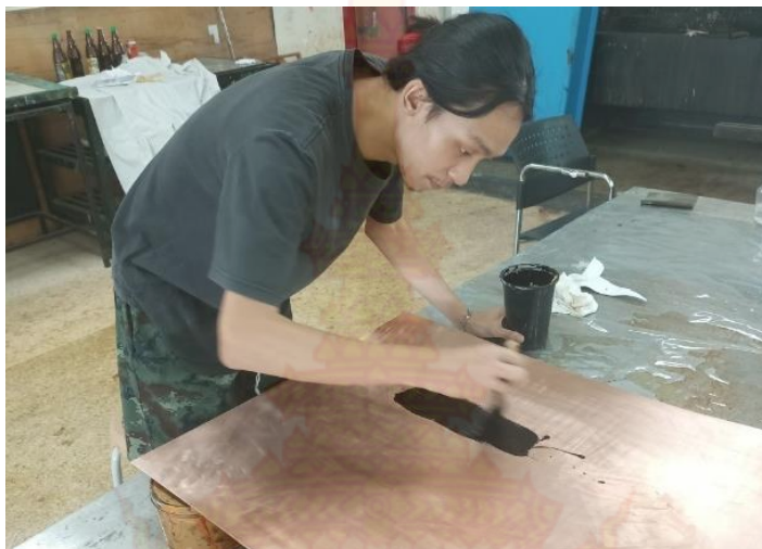
ภาพที่ 22 การทาวานิชที่แม่พิมพ์ทองแดง
