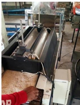
รูปที่ 3 การทำงานของเครื่องกำจัดแมลงในข้าวสารโดยใช้ความร้อนจากรังสีอินฟราเรดต้นแบบ
