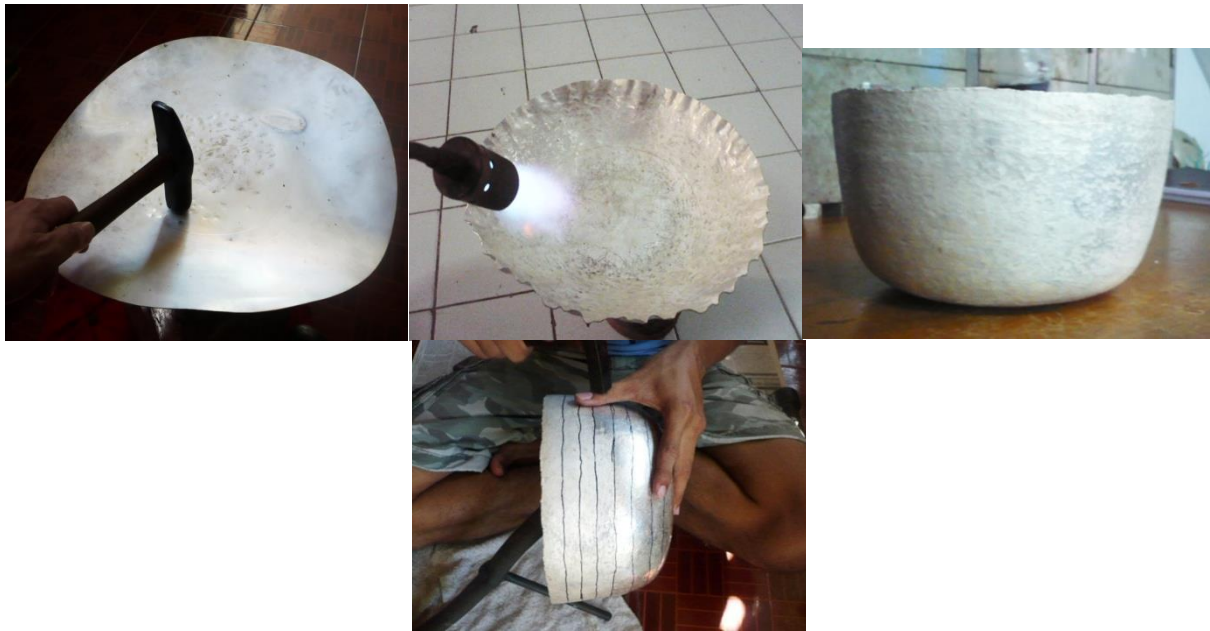
ภาพที่ 4 การขึ้นรูปแผ่นโลหะเงิน
