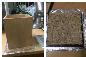
ภาพที่ 11 ขั้นตอนการทำ อัดกับพิมพ์และกดให้เข้ารูปนำพิมพ์ออกและเอาเข้าเครื่องอัดร้อน อุณหภูมิ 120 องศา เวลา 10 นาที
