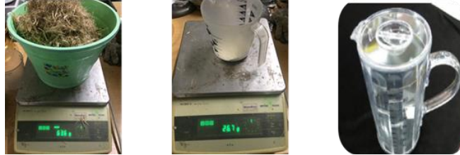
ภาพที่ 9 ขั้นตอนการทำ ชั่งน้ำหนักใยกล้วย แป้ง และน้ำตามสูตรที่คำนวณได้
