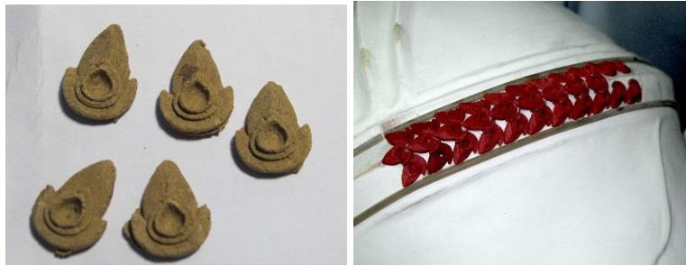
รูปที่ 3 รูปลายกระจิง จากวัสดุทดแทนรักติลายสูตรผสมที่ 3 ผงไม้ผสมปูนยาแนว
