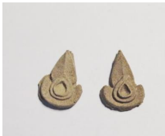
รูปที่ 4 รูปปลายกระจิง จากวัสดุทดแทนรักติลายสูตรผสมที่ 4 ผงไม้ผสมกาวผงไม้
