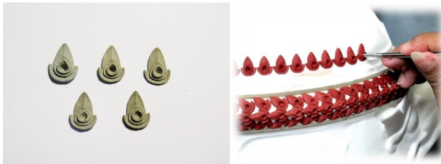
รูปที่ 1 รูปถ่ายกระบัง จากวัสดุทดแทนรักติลายสูตรผสมที่ 1 อีพ็อกซีผสมผงไม้
