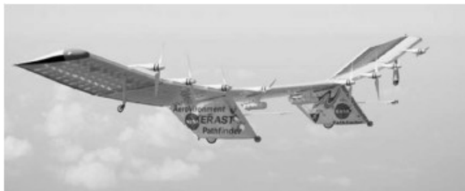
ภาพที่ 3 Pathfinder-UAV ใช้พลังงานแสงอาทิตย์ ที่บินอยู่เหนือเกาะคาไวอิ (Kauai) รัฐฮาวาย สหรัฐอเมริกา ได้ติดตั้งกล้องไว้ที่ศูนย์กลางของปีกเพื่อถ่ายรูปทางด้านเกษตรกรรม ที่มา : S.R. Herwitz และคณะ (2004)
