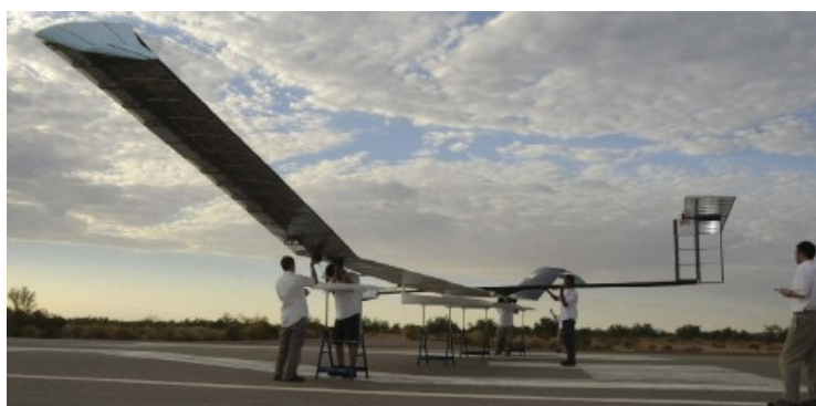
ภาพที่ 4 ระบบอากาศยานไร้คนขับ Zephyr (UAS) ออกแบบและผลิตโดยองค์การวิจัยและเทคโนโลยี QinetiQ ลงจอดหลังจากบินอยู่ในอากาศนาน 14 วัน 21 นาที พลังงานที่ใช้ทั้งหมดได้จาก รังสีอาทิตย์ ที่มา : George Marsh (2010)
