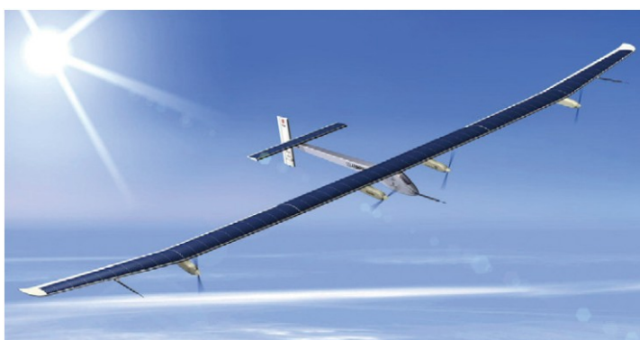
ภาพที่ 5 เครื่องบินต้นแบบพลังงานแสงอาทิตย์ Solar Impulse HB-HIA สร้างโดยใช้วัสดุคาร์บอนไฟเบอร์/sandwich composites ที่มา : Reinforced plastic (2009)
