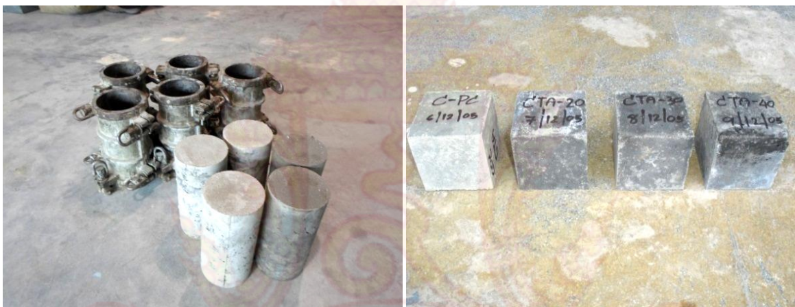
รูปที่ 1.1 ตัวอย่างทดสอบรูปทรงกระบอกและทรงลูกบาศก์
