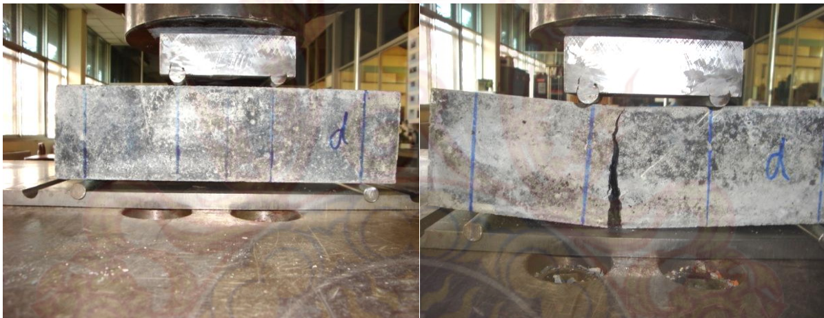
รูปที่ 1.6 การทดสอบแรงดึงโดยวิธีการดัด
