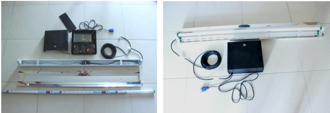
รูปที่ 7 (ก) ส่วนประกอบชุดควบคุมความสว่างแบบอัตโนมัติ (ข) ชุดควบคุมความสว่างแบบอัตโนมัติที่พร้อมนำไปติดตั้ง
