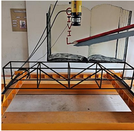
รูปที่ 8 ลักษณะการเสียรูปของโครงถักที่ไม่เอียงศูนย์
