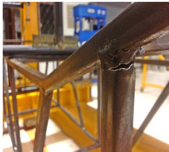
รูปที่ 9 ลักษณะการเสียรูปของโครงถักที่เอียงศูนย์ 16 เซนติเมตร
