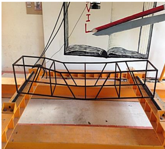
รูปที่ 9 ลักษณะการเสียรูปของโครงถักที่เอียงศูนย์ 16 เซนติเมตร
