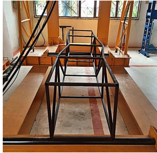
รูปที่ 8 ลักษณะการเสียรูปของโครงถักที่ไม่เอียงศูนย์
