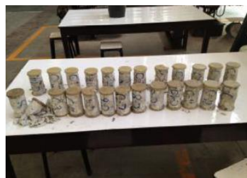
รูปที่ 6 เจาะเก็บตัวอย่างแท่งคอนกรีตด้วยวิธี coring
