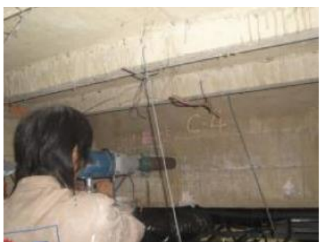
รูปที่ 6 เจาะเก็บตัวอย่างแท่งคอนกรีตด้วยวิธี coring
