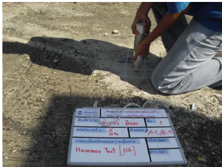
รูปที่ 4 ทดสอบกำลังอัดประลัยของคอนกรีต ด้วยวิธี Rebound Hammer-Schmidt
