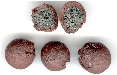
รูปที่ 2 ลักษณะผิวนอกและภายในของเม็ดดินเผามวลเบา (ที่มา : วิชัย, 2523)
