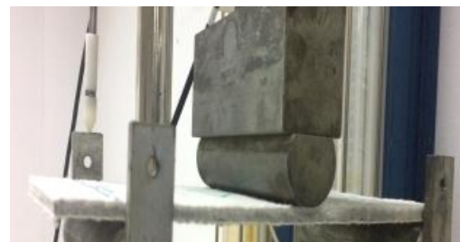
(b) ผ้าใบคอนกรีตหลังพรมน้ำและปล่อยให้แข็งตัว
