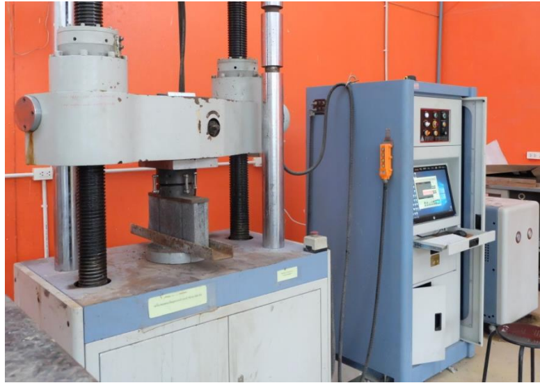
รูปที่ 5 การทดสอบความต้านทานแรงอัดของก้อนตัวอย่างคอนกรีตบล็อก
