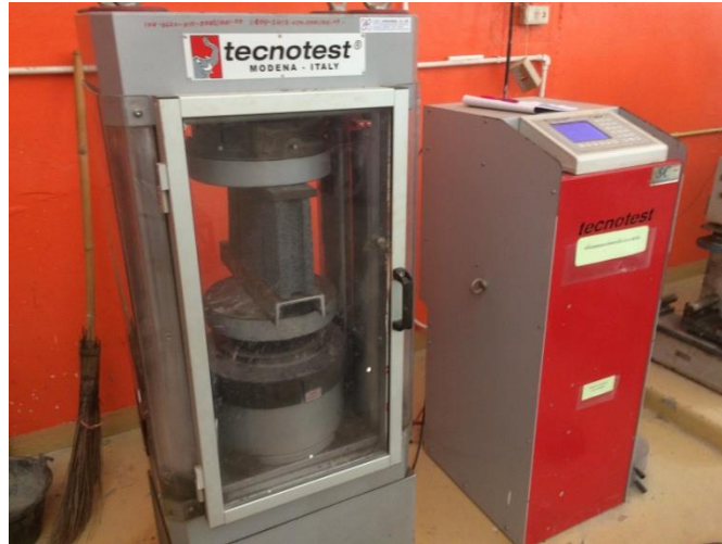
รูปที่ 6 การทดสอบความต้านทานแรงอัดของก้อนตัวอย่างคอนกรีตบล็อก
