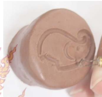
ภาพที่ 102 ใช้เครื่องมือขูดลายร่องลึกตามแบบ
