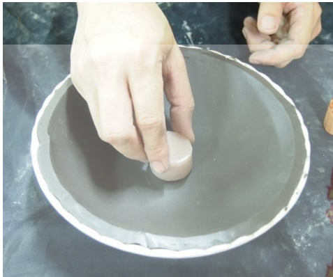
ภาพที่ 126 ใช้ลายกดประทับวัสดุเรซิน
