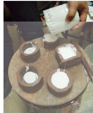
ภาพที่ 108 เทพิมพ์ชิลิโคนในแบบที่เตรียมไว้
