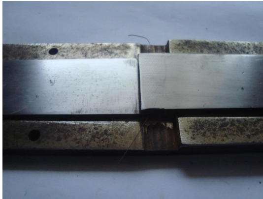
ภาพที่ 19 ติดตั้งชิ้นงานลงบนอุปกรณ์จับยึด
