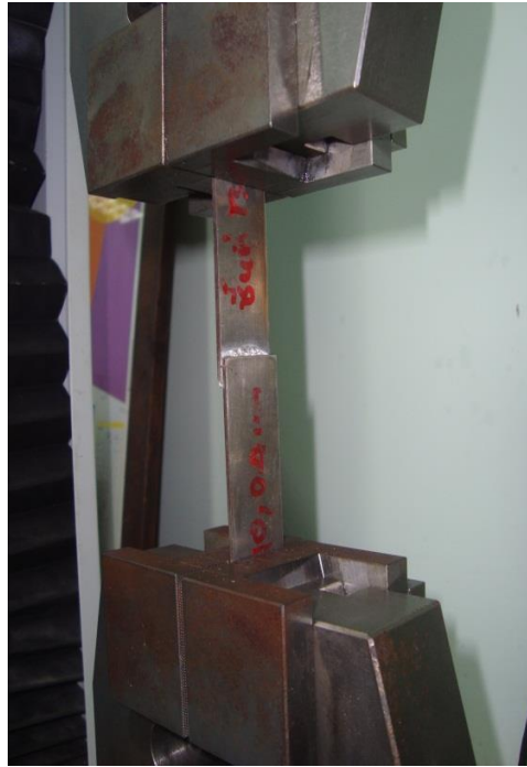
ภาพที่ 23 ตัวอย่างชิ้นงานทดสอบความต้านทานแรงเฉือน
