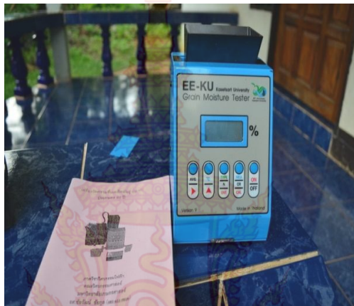
ภาพที่ 3-22 เครื่องวัดความชื้นข้าวเปลือก
