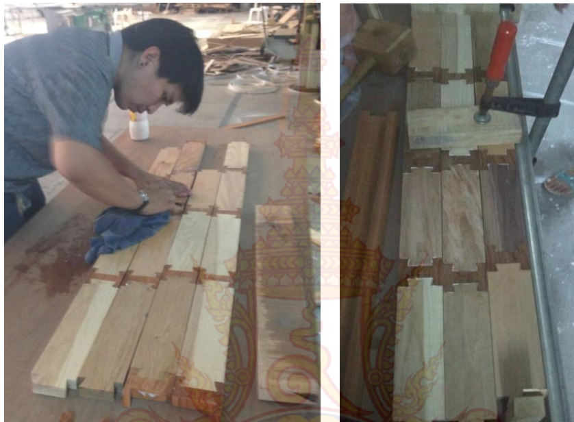
ภาพที่ 3 - 28 แสดงภาพการเพาะไม้ด้วยอุปกรณ์อย่างง่ายเพาะในแนวกว้าง (การใช้เครื่องอัดจะได้ไม้ที่มีความแข็งแรงของรอยต่อมากกว่า แต่ขึ้นอยู่กับคุณสมบัติของกาวที่เลือกใช้)
