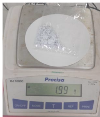
รูป 32 น้ำหนักเศษกระดาษหลังทำการทดลองที่แรงดันไฟฟ้า 4 โวลต์
