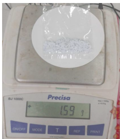
รูปที่ 31 น้ำหนักเศษกระดาษหลังทำการทดลองที่แรงดันไฟฟ้า 2 โวลต์
