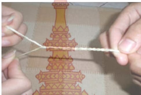
ภาพที่ 33 ภาพแสดงขั้นตอนการตีเกลียวตีเกลียวด้วยมือ
