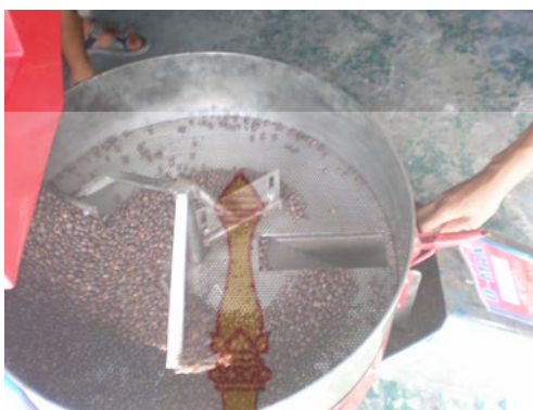
รูปที่ 4.4 แสดงการระบายความร้อนของเมล็ดกาแฟ หลังจากที่คั่วเสร็จแล้ว
