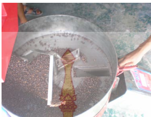
รูปที่ 4.12 แสดงการระบายความร้อนของเมล็ดกาแฟหลังจากที่คั่วเสร็จแล้ว
