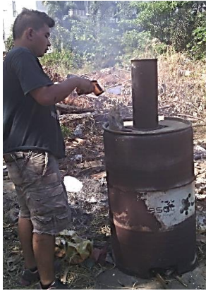
รูปที่ 3: การวัดอุณหภูมิการเผาไหม้จากเตาเผาถ่านไบโอชาร์
