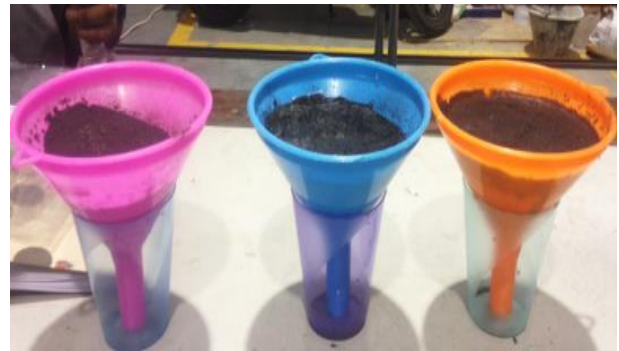
รูปที่ 6: การวัดปริมาณการอุ้มน้ำของถ่านไบโอชาร์จากต่อซังและฟางข้าว
