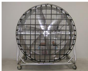
รูปที่ 4: อุโมงค์ลมขนาดเส้นผ่านศูนย์กลาง 1.2 m
