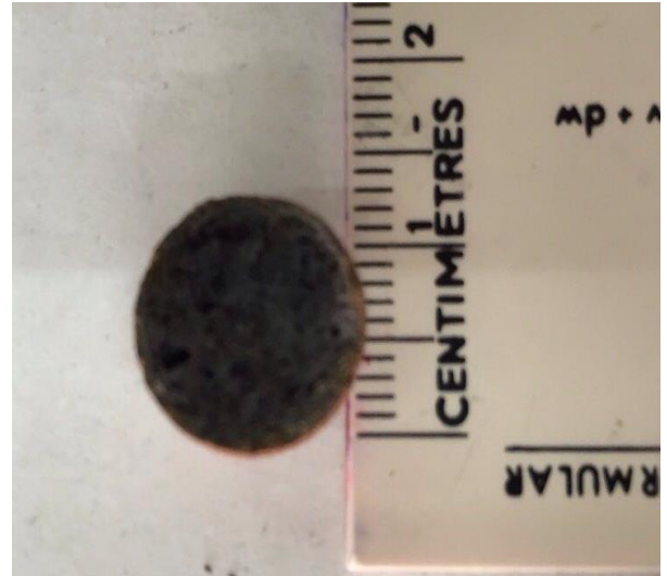
(ข) ลักษณะของเม็ดดินเผาที่ผ่านการเผาในอุณหภูมิที่ 1,200 องศา
