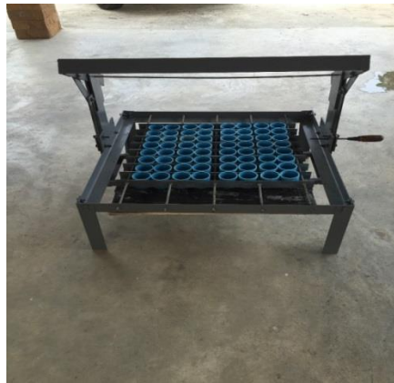
รูปที่ 2 : อุปกรณ์ทำลูกปูนตามแนวปรัชญาเศรษฐกิจพอเพียงพร้อมใช้งาน
