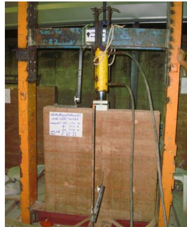
รูปที่ 3 : รูปแบบการทดสอบแรงกดอัดของผนัง
