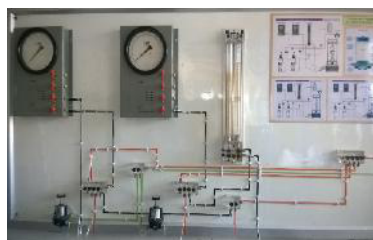
รูปที่ 5 อุปกรณ์ประกอบชุดเครื่องมือทดสอบแรงอัดแบบสามแกน
