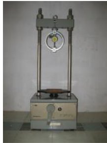
รูปที่ 2 เครื่องกวดตัวอย่างดิน
