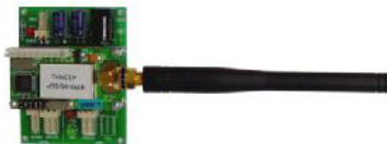
รูปที่ 3 โมดูลรับ-ส่งข้อมูลด้วยคลื่นวิทยุ รุ่น YS1020L
