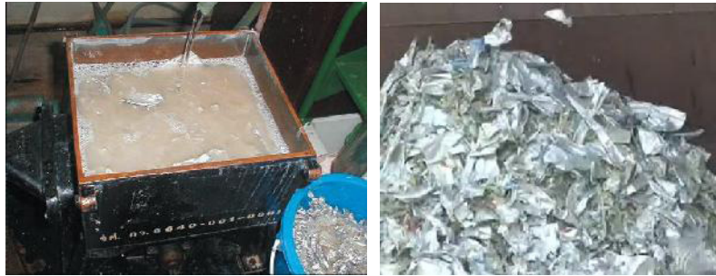
ภาพที่ 7 การตัดแยกขนาดด้วยเครื่องตัดแยกเยื่อแบบตะแกรงราบ
