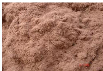
ภาพที่ 6 แสดงการนำขุยมะพร้าวไปอบที่อุณหภูมิ 100 องศาเซลเซียส เป็นเวลา 4 ชั่วโมง
