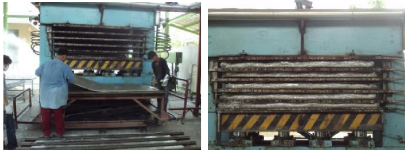
ภาพที่ 8 แสดงการอัดร้อนของแผ่นกระเบื้อง
