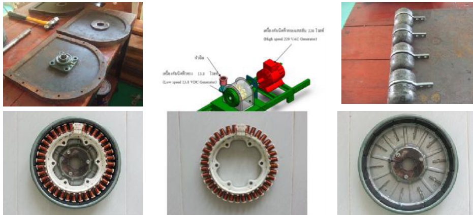
รูปที่ 3 การพัฒนาการใช้งานระบบกลุ่มของกังหันน้ำ สำหรับผลิตกระแสไฟฟ้า สำหรับไฟฟ้าแสงสว่างภายในหมู่บ้าน แบบ Stand alone ขนาด 2 KW โดยติดตั้ง เจเนอเรเตอร์ AC และ เจเนอเรเตอร์ DC รอบตัว ไ่ว้นแกนขับเดียวกัน เพื่อแก้ปัญหาความไม่คงที่ของน้ำ
