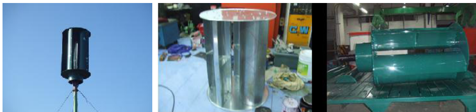
รูปที่ 4 การพัฒนาการใช้งานระบบกลุ่มของกังหันลมที่ใช้งานพื้นที่สูงบนภูเขา สำหรับผลิตกระแสไฟฟ้า สำหรับไฟฟ้าแสงสว่างภายในหมู่บ้าน แบบ Stand alone โดยการปรับปรุงโครงสร้างใบและเพลากังหัน ให้คงทนกับสภาพของลมภูเขา และลมกรรโชกได้
