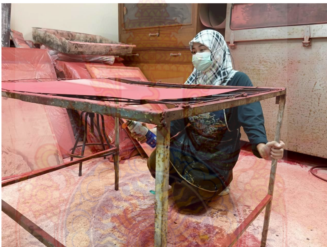
ภาพที่ 66 ขั้นตอนการย่างแม่พิมพ์
