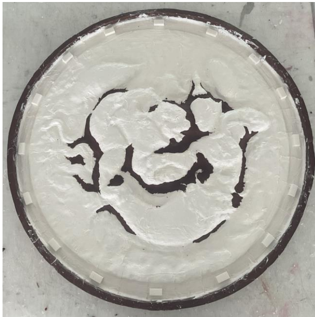
ภาพที่ 3.94 ภาพแสดง : ใช้ดินน้ำมันกั้นลูกพิมพ์และทาวาสลีน
