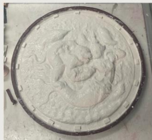
9. ทายางซิลิโคนชั้นที่4และวางเดือย และทำกรอบต่อไป
