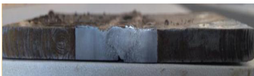
รูปที่ 9 แสดงการซึมลึกของแนวเชื่อมจากการเชื่อมต่อน โดยใช้ก๊าซชีวภาพเป็นเชื้อเพลิง
