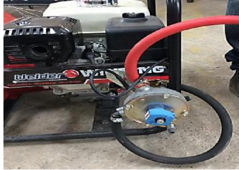
รูปที่ 3 การติดตั้งระบบก๊าซเข้ากับเครื่องเชื่อมไฟฟ้าประเภทเครื่องยนต์ขนาด 5.6 แรงม้า
