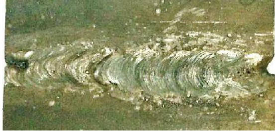
รูปที่ 11 แสดงแนวเชื่อมจากการเชื่อมต่อชนโดยใช้ก๊าซชีวภาพ
