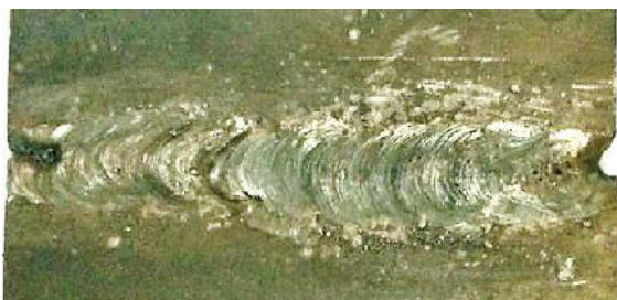
รูปที่ 8 แสดงแนวเชื่อมจากการเชื่อมต่อน โดยใช้ก๊าซชีวภาพเป็นเชื้อเพลิง
