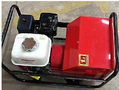
รูปที่ 1 เครื่องเชื่อมไฟฟ้าประเภทเครื่องยนต์ขนาด 5.6 แรงม้า
