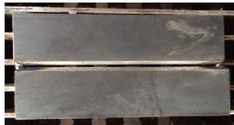
รูปที่ 5 แสดงการเตรียมชิ้นงานเชื่อมต่อชน
