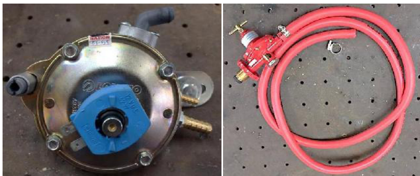
รูปที่ 2 หม้อต้มก๊าซ, วาล์วปรับแรงดันหัวถังและท่อก๊าซ
