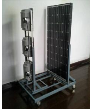
รูปที่ 1: ชุดแสดงการทำงานของแสงอาทิตย์เทียมและแผงเซลล์แสงอาทิตย์
