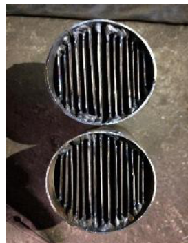
รูปที่ 4 ออกแบบท่อทำความร้อนจากโลหะ
