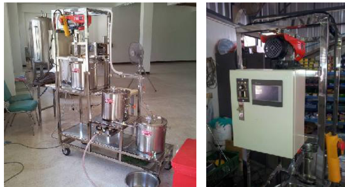
รูปที่ 2 เครื่องพาสเจอร์โรสแบบกึ่งอัตโนมัติที่นำเสนอ
