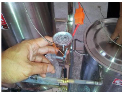
รูปที่ 6 การวัดอุณหภูมิของวัตต์ดูบิลที่ผ่านการให้ความร้อนแล้ว
