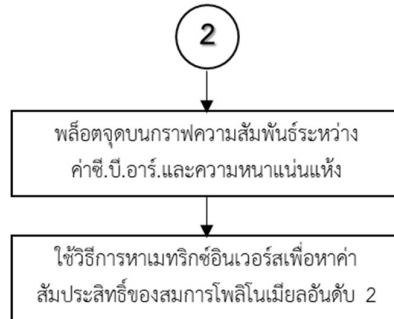
รูปที่ 7 ขั้นตอนการเขียนกราฟความสัมพันธ์ระหว่างค่าซี.บี.อาร์.และความหนาแน่นแห้ง
