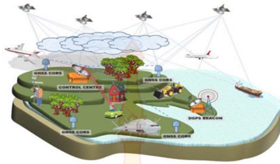
ภาพที่ 2.1 ระบบโครงข่ายการรังวัดด้วยดาวเทียมแบบจลน์ (RTK GNSS NETWORK) ที่มา: กรมที่ดิน กองเทคโนโลยีทำแผนที่, http://dol-rtknetwork.com/uploads/files/listdownload/RTK%20GNSS%20Network%20DOL.pdf , 24 สิงหาคม 2560.
