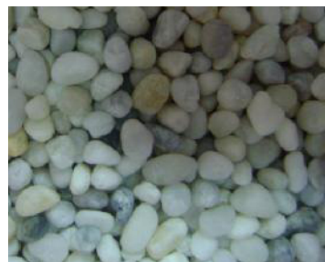
รูปที่ 4 หินตุ้ปลา (The pebbles) ที่เลือกใช้เป็นวัสดุพูนชนิดเม็ดกลมอัดแน่นในการทดลอง
