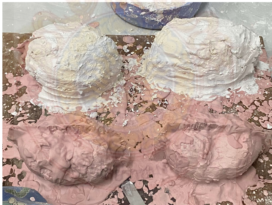
ภาพที่ ๗๑ การหล่อการทำพิมพ์ผิวชั้นแรก แล้วการทำความหนาพิมพ์ชั้นที่ ๒
