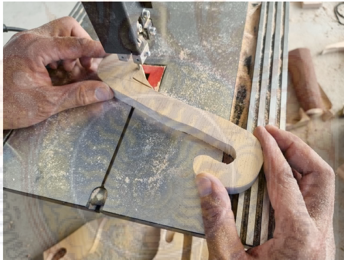
ภาพที่ ๒๑ : ภาพแสดงกระบวนการตัดชิ้นส่วนโครงสร้างแขนตะขอตามขนาดที่วัดด้วยแม่พิมพ์กระดาษ
