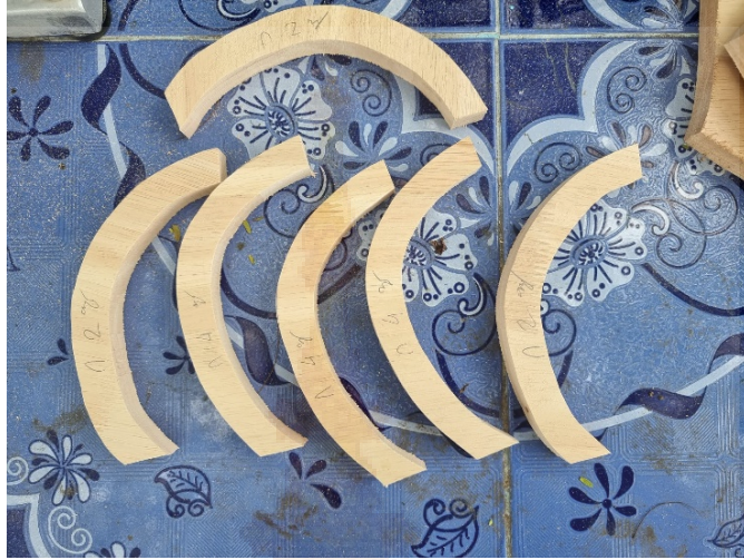
ภาพที่ ๒๐ : ภาพแสดงกระบวนการตัดชิ้นส่วนโครงสร้างตามขนาดที่วัดด้วยแม่พิมพ์กระดาษ
