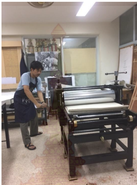
ภาพที่ 36 หมุนแท่นพิมพ์ ที่มา : ข้อมูลจากผู้เขียน
